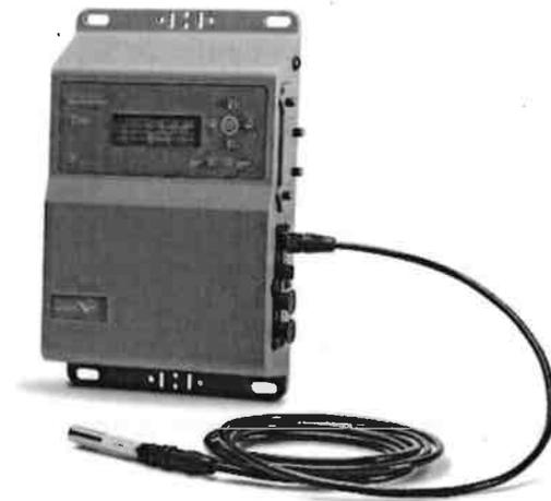
Photo 11: *Détecteur d'ultrasons automatique de type SM3bat - Source Wildcare*
