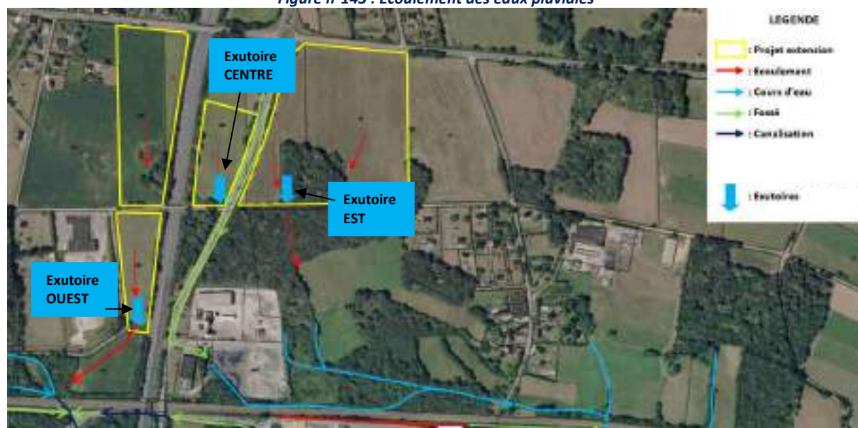
Figure n°143 : Ecoulement des eaux pluviales
